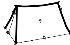
太線で示した各辺をダイナマ®テープで補強
