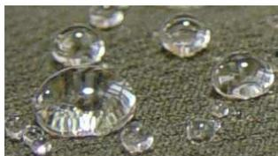
丈夫で張り腰のある生地にストレッチ性を持たせることは、困難なことでした。我々は引裂きと摩擦に強いスパンライクナイロン(66ナイロン)にポリウレタンを組み合わせたストレッチ糸を縦横に織り上げて、更に収縮加工を施し生地表面の凹凸化と縦横のストレッチ性を発現することに成功しました。
