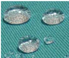
ニットにおける最高水準の耐久撥水性、洗濯100回後においても撥水度80点以上(JIS-L1092法)、を実現。高度耐久撥水性能により、磨耗・汚れ・洗濯等による撥水性能の低下を抑制します。
