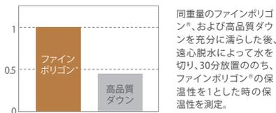
【スリーピングバッグ乾燥試験】(当社試験データ)
